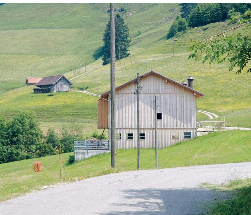
Die Funktionsflächen dieser Scheune wurden auf 3 Ebenen verteilt. Im oberen Geschoss befindet sich das Heulager und der Kälberstall, darunter der Jungviehstall, dessen Laufhof über dem Güllelager liegt. Die Lage am Hang ermöglicht eine Erschliessung im oberen Gebäudeteil.
