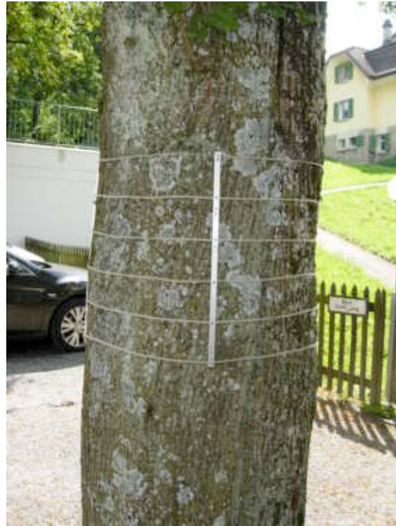
Abb. 1: Das Frequenzgitter wird so an die Stammfläche angebracht, dass 10 gleich grosse Felder entstehen
