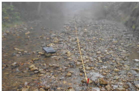
Bild 1: Im Bachbett ausgelegtes Messband zur Erhebung einer Linienprobe. Bestimmt wurde der Durchmesser der b-Achse aller Steine > 1 cm anhand von 21 Grössenklassen. Der Anteil der feineren Substrate wurde pauschal geschätzt.
