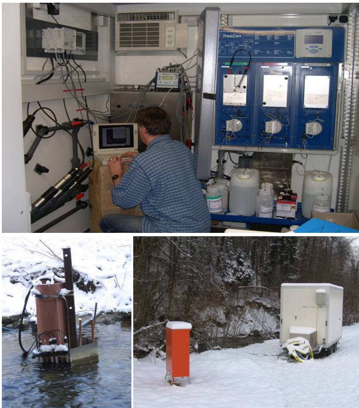
Abbildung 1: Einsatz Online-Messwagen an der Glatt unterhalb ARA Oberglatt
